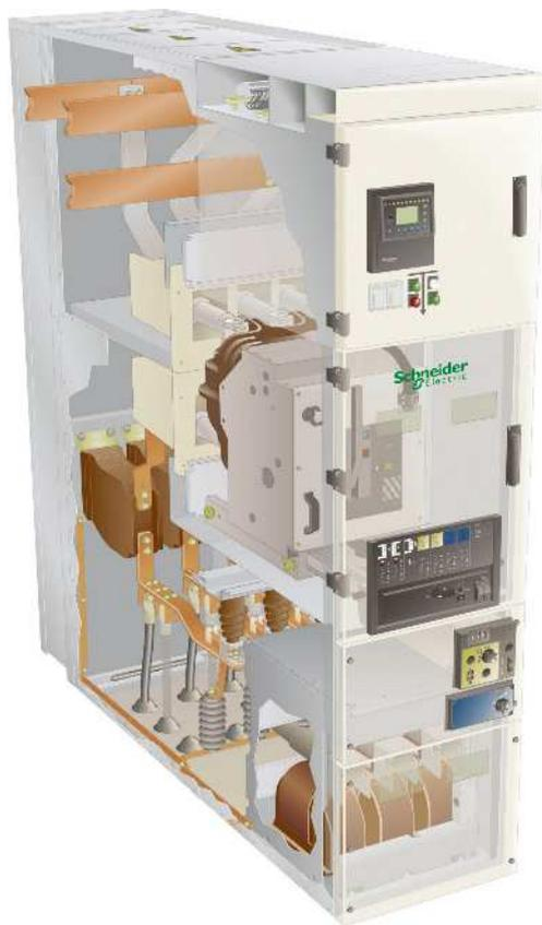
La cellule est du type LSC2B (Loss of Service Continuity Category) au sens défini par la norme CEI 62271-200, c'est-à-dire que les parties HTA sont compartimentées par des cloisons métalliques (classe PM : Partitionning Metallic) reliées à la terre qui séparent entre eux :
